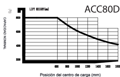
GRÁFICO DE CAPACIDADES NOMINALES Y CENTROS DE CARGA
