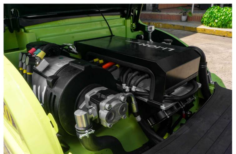
El mayor ángulo de apertura del capó facilita significativamente la revisión y el mantenimiento del montacargas, proporcionando un acceso más cómodo y eficiente a los componentes internos.
